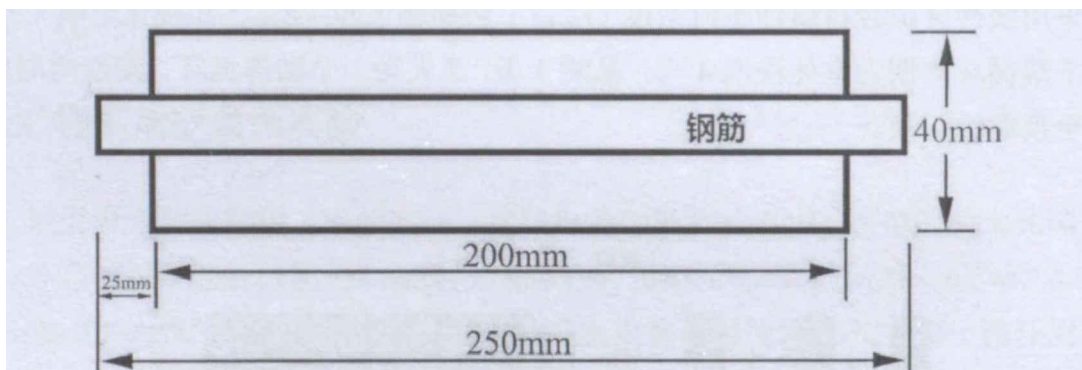
图 7-2 实海投洋混凝土样品示意图
